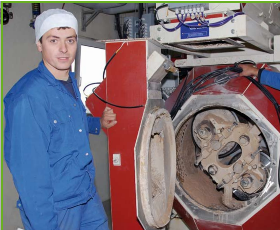
Beispiel Mühlenprodukte: In der Kleiepresse zur Futterherstellung könnte es zu einem Kontakt zwischen Schmierfetten und Futterpellets kommen.
