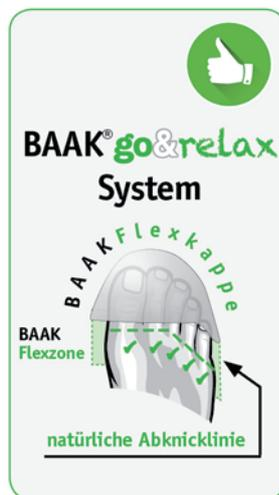
Aufgrund der geraden Zehenschutzkappen und zu steifer Laufsohlen, werden durch die unnatürliche Biegelinie herkömmlicher Schuhe nur noch der große Zeh und die beiden daneben liegenden in die Abrollbewegung einbezogen. Die zwei äußeren kleinen Zehen bleiben weitgehend unberücksichtigt. Das bedeutet: Fehlbelastungen für Füße, Muskeln und Gelenke bei jedem Schritt.
